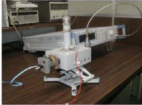
Figura 3.5: Generador de microondas alimentando a la línea ranurada.
