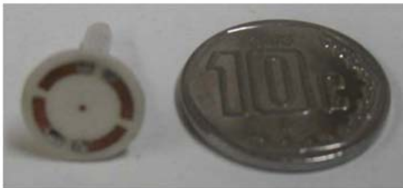
Figura 1.6: Elemento radiador del arreglo reflectivo propuesto.
