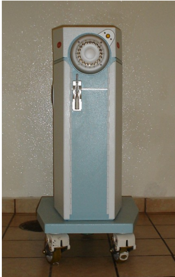
Figura 1.6 Equipo Varisource para braquiterapia de alta tasa de dosis, de carga diferida con control remoto.
