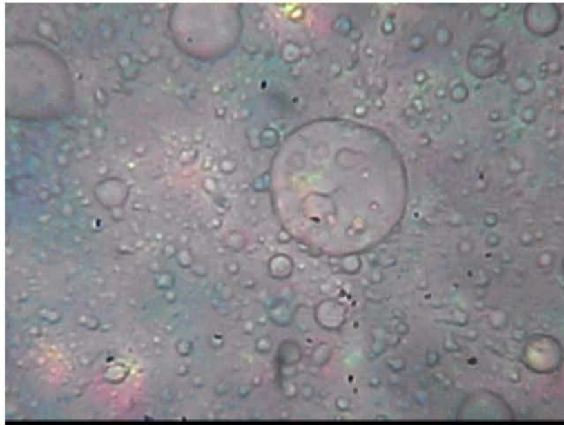
Figura 6.1. Microscopía óptica de la emulsión w/o/w 0.25% lecitina, 3% poloxamero
