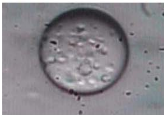
Figura 6.4. Microscopía óptica de la emulsión w/o/w, 0.5% lecitina y 3% poloxámero
