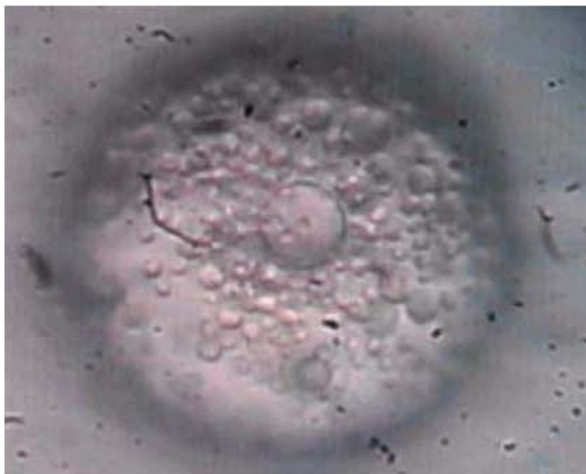
Figura 6.3. Microscopía óptica de la emulsión w/o/w, 0.5% lecitina y 3% poloxámero
