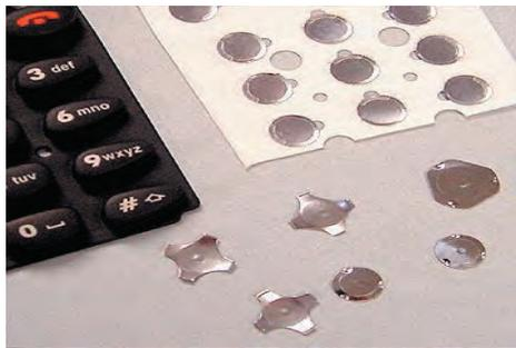
(Click domes) Elementos de contacto entre los botones y la tarjeta electrónica
