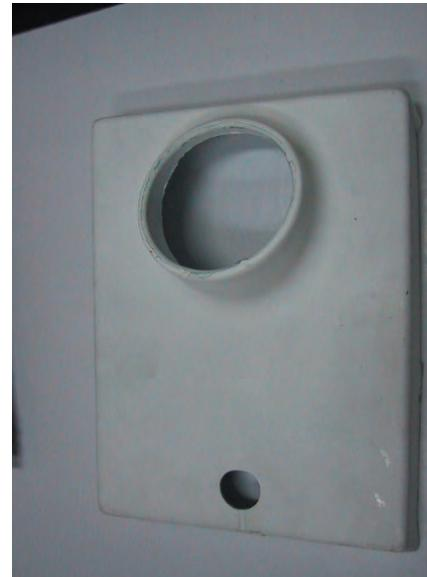
Pieza de estireno termoformada
