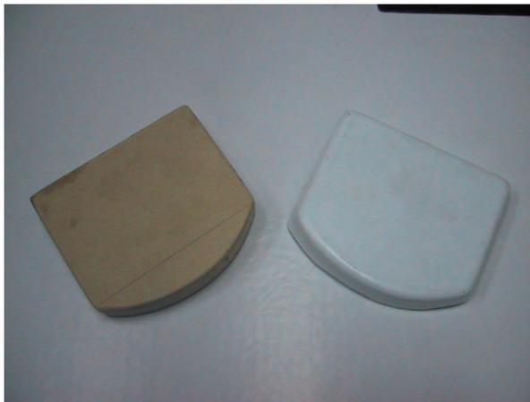
Molde MDF y pieza termoformada en estireno.
