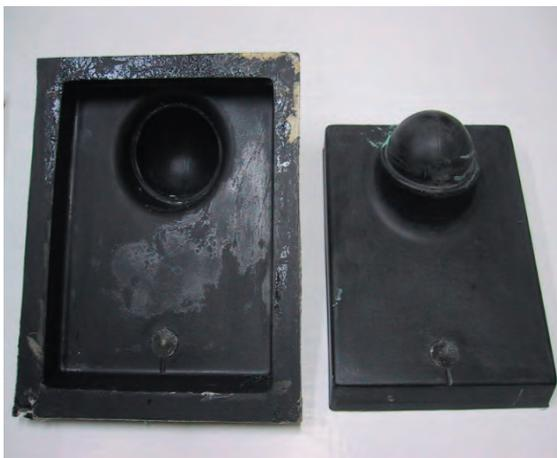
Para esta parte se requirió emplear materiales tales como MDF, laminas de estireno para termoformar y la fibra de vidrio.
