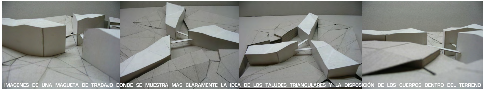
IMÁGENES DE UNA MAQUETA DE TRABAJO DONDE SE MUESTRA MÁS CLARAMENTE LA IDEA DE LOS TALUDES TRIANGULARES Y LA DISPOSICIÓN DE LOS CUERPOS DENTRO DEL TERRENO
