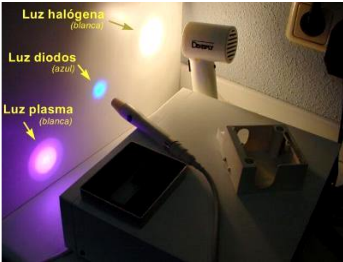
Color original de la luz sin filtrar de la luz emitida por bombilla halógena, de plasma y LEDs.
