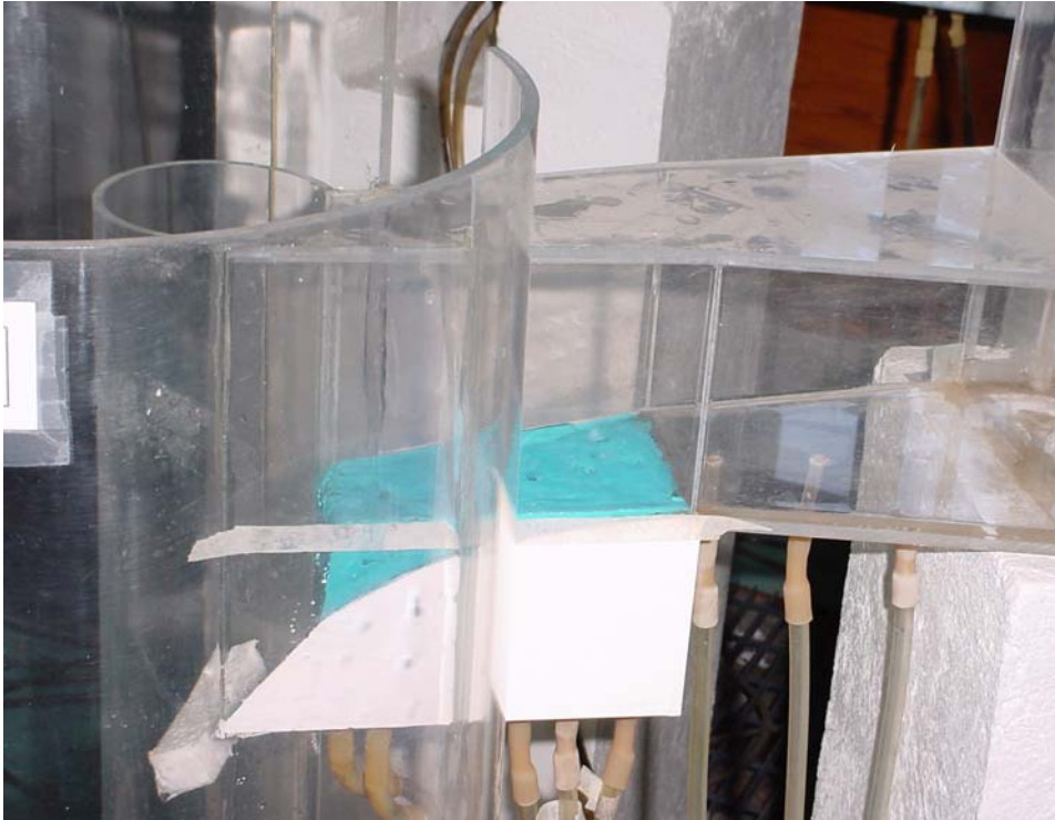
Foto 11. Vista del canal de llegada sin cimacio S=0
