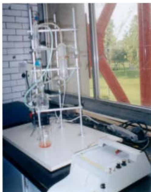
Figura 11. Sistema Langendorff para el estudio de la reactividad vascular en el riñón de rata aislado perfundido con solución Krebs.
