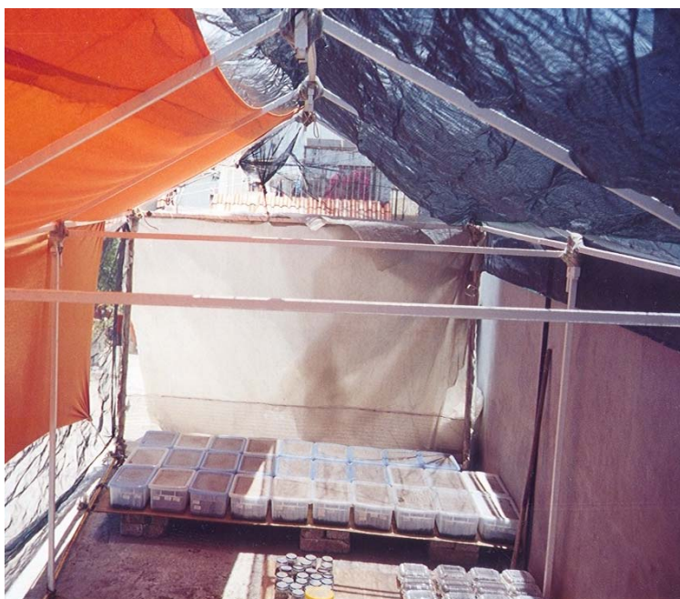
Figura 7. Estructura metálica con cubierta de malla plástica de color negro, bajo la cual estuvieron los tratamientos experimentales del presente trabajo.
