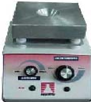
FIGURA 4: PARRILLA DE AGITACIÓN Y CALENTAMIENTO TEMPERATURA MÁXIMA 350° C
