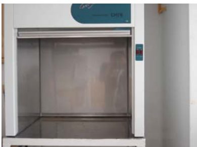
CAMPANA DE EXTRACCIÓN
