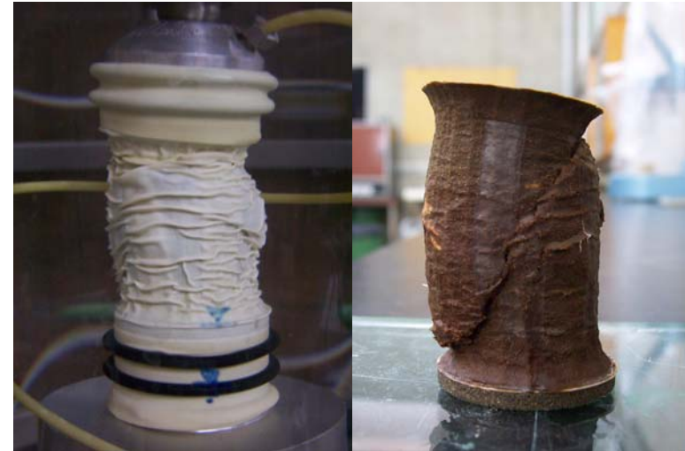
Foto 5.18. Probeta OCR = 11.8, 1 %/h
