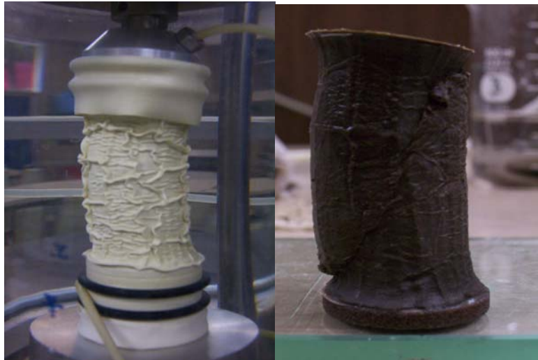
Foto 5.1. Probeta OCR = 1, 0.1 %/h
