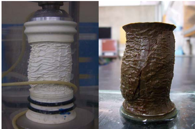
Foto 5.9. Probeta OCR = 6, 0.1 %/h
