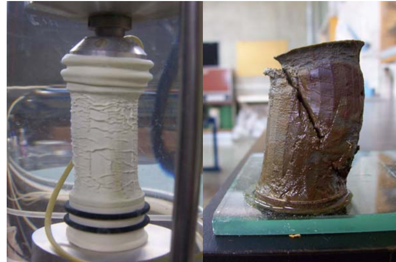
Foto 5.6. Probeta OCR = 3, 1 %/h
