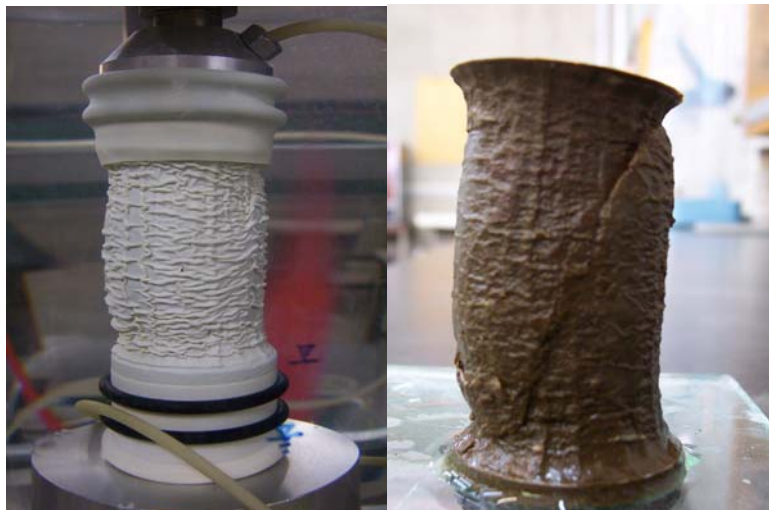
Foto 5.11. Probeta OCR = 6, 10 %/h
