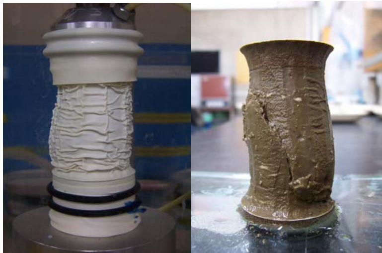
Foto 5.15. Probeta OCR = 8, 10 %/h
