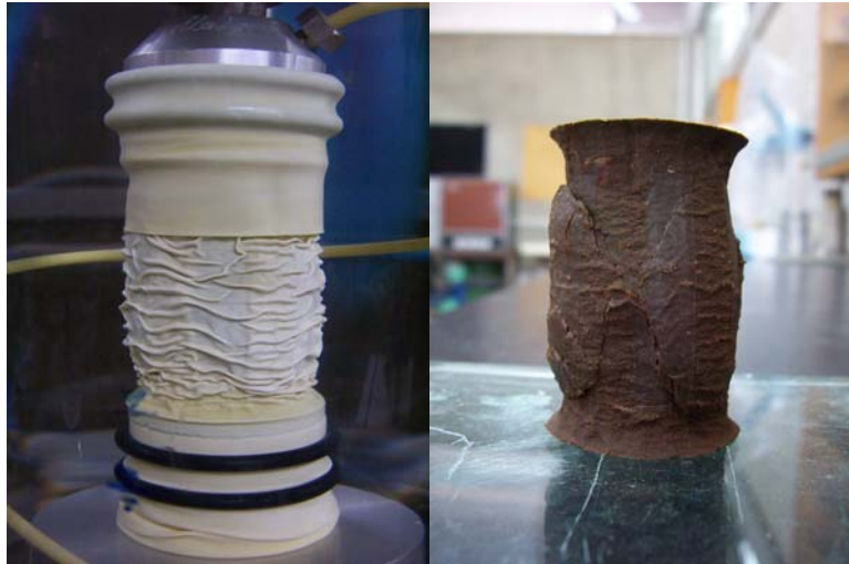
Foto 5.17. Probeta OCR = 11.8, 0.1 %/h
