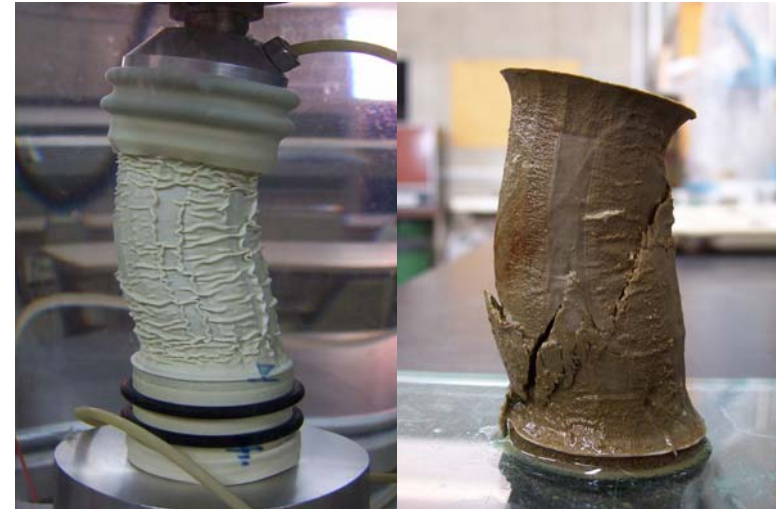
Foto 5.16. Probeta OCR = 8, 100 %/h
