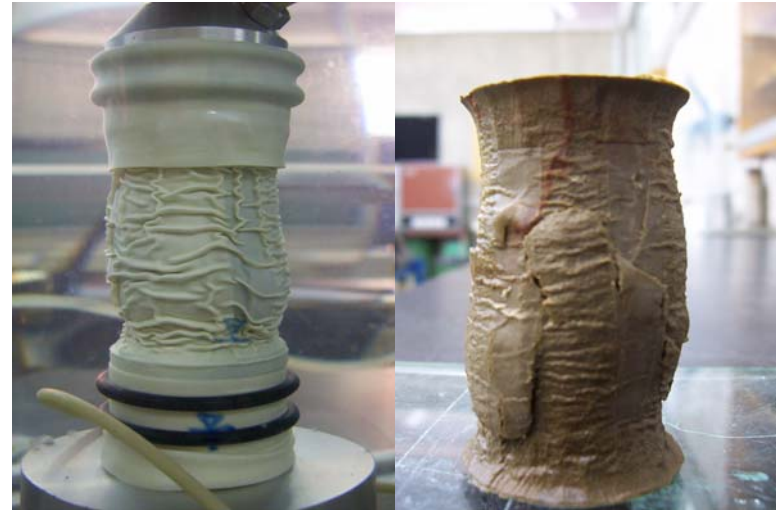
Foto 5.14. Probeta OCR = 8, 1 %/h
