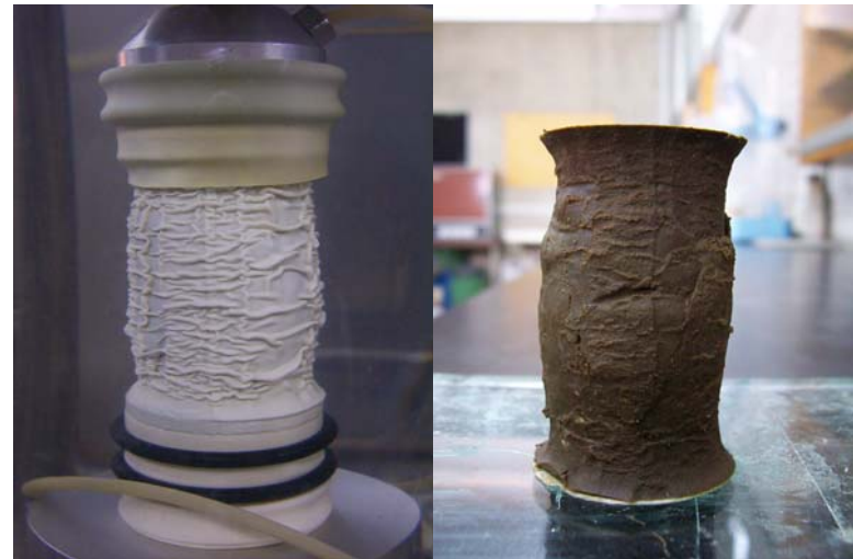
Foto 5.12. Probeta OCR = 6, 100 %/h
