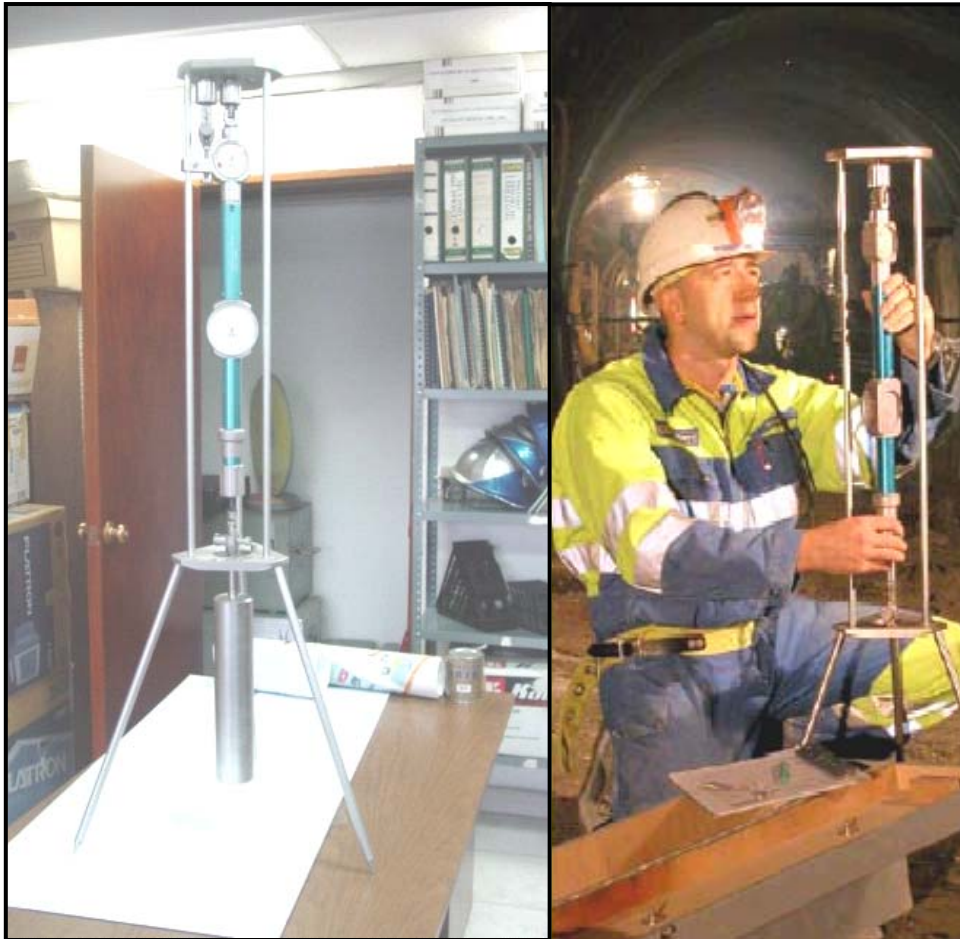
FOTOGRAFÍA II.2 CALIBRACIÓN DE EXTENSÓMETRO DE ALAMBRE
