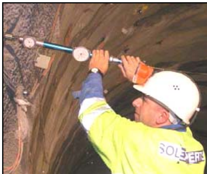
FOTOGRAFÍA II.3 MEDICIONES CON DISTOMETER ISETH
