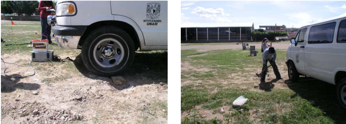
Figura 4.2.2.4. Izquierda, vista de la tabla sujeta al suelo, antes de dar los golpes. Derecha, toma durante la aplicación de los impactos en el tiro de ida; al fondo se observa el tendido lineal.
