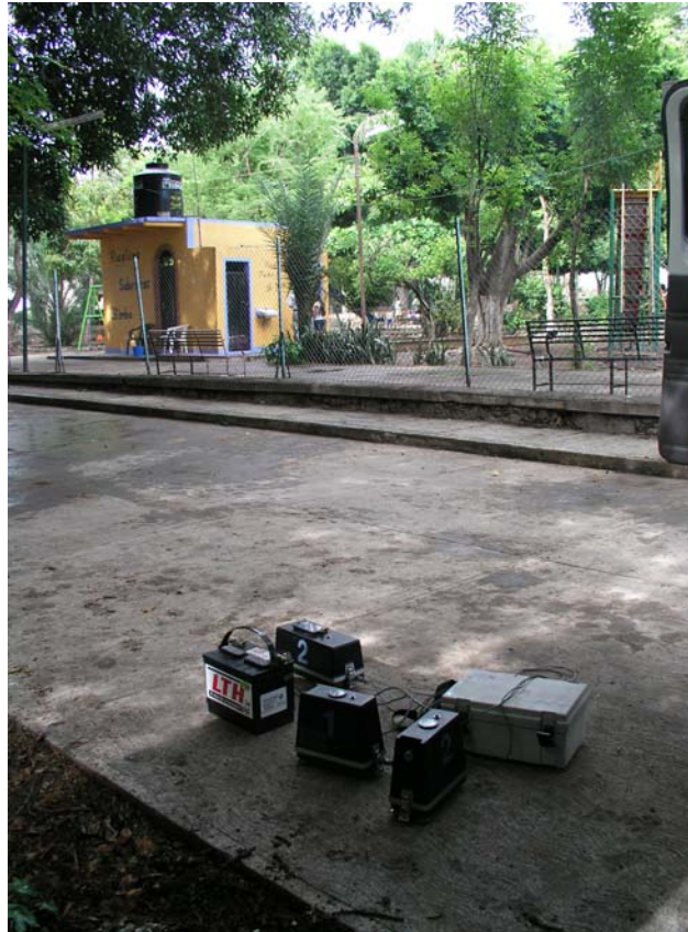
Figura 4.2.1.2. Sistema de adquisición de datos para el registro de microtremores.
