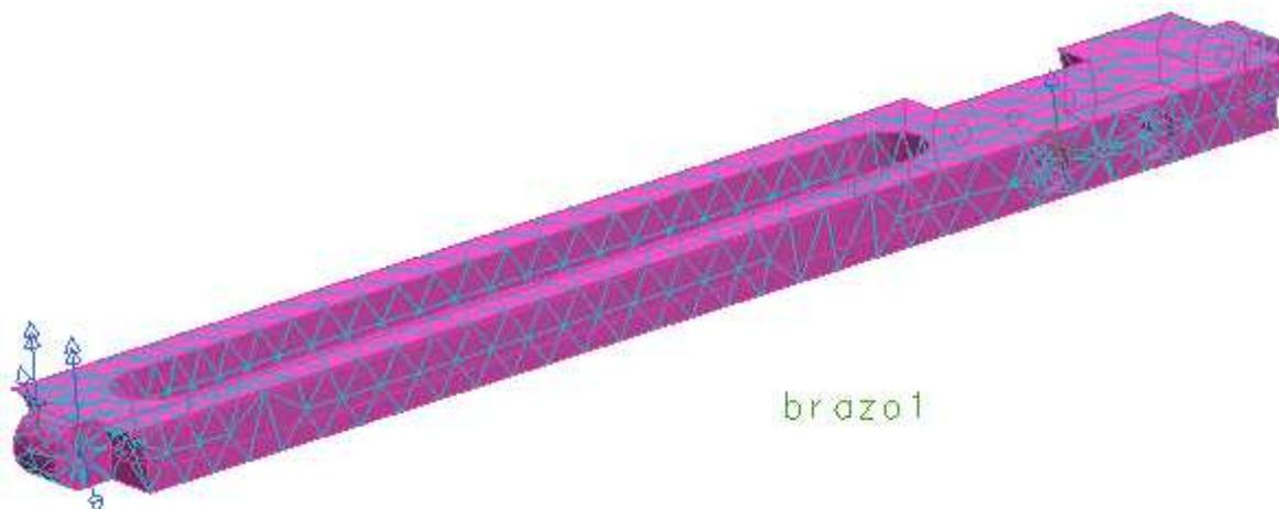
**Fig. 3.12 Brazo mallado con cargas.**
