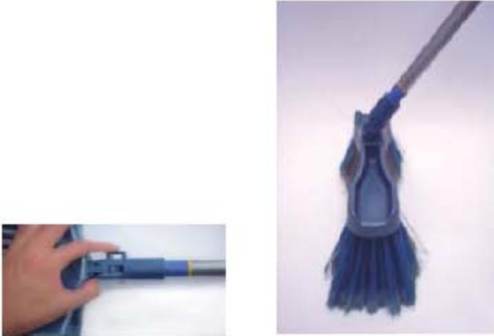
La escoba del lado derecho está fabricada con un ángulo lateral que no es muy eficiente debido a que es limitada el área de material para el barrido.
