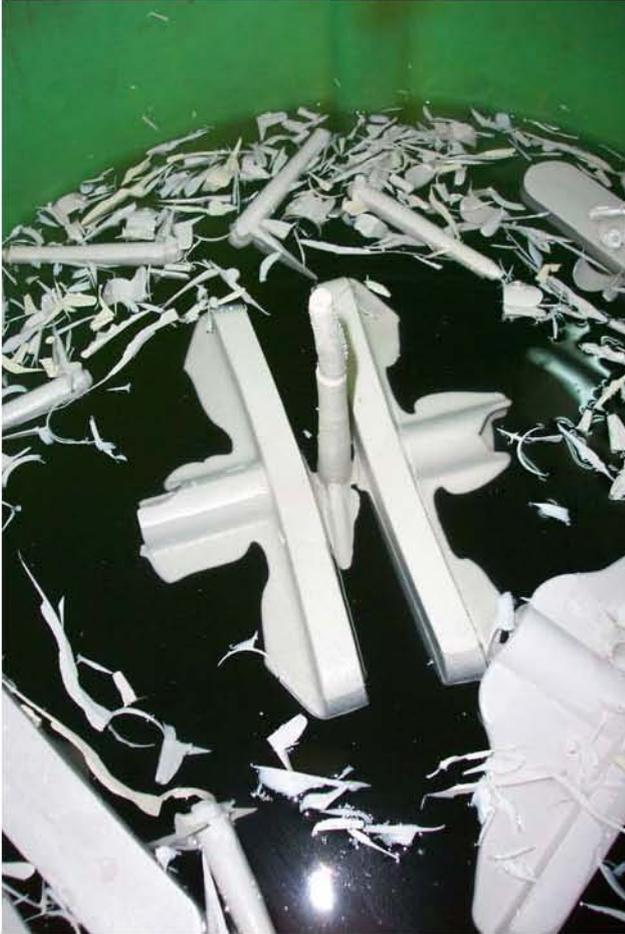
Las piezas recién inyectadas son depositadas en agua para obtener un enfriamiento sin deformaciones
