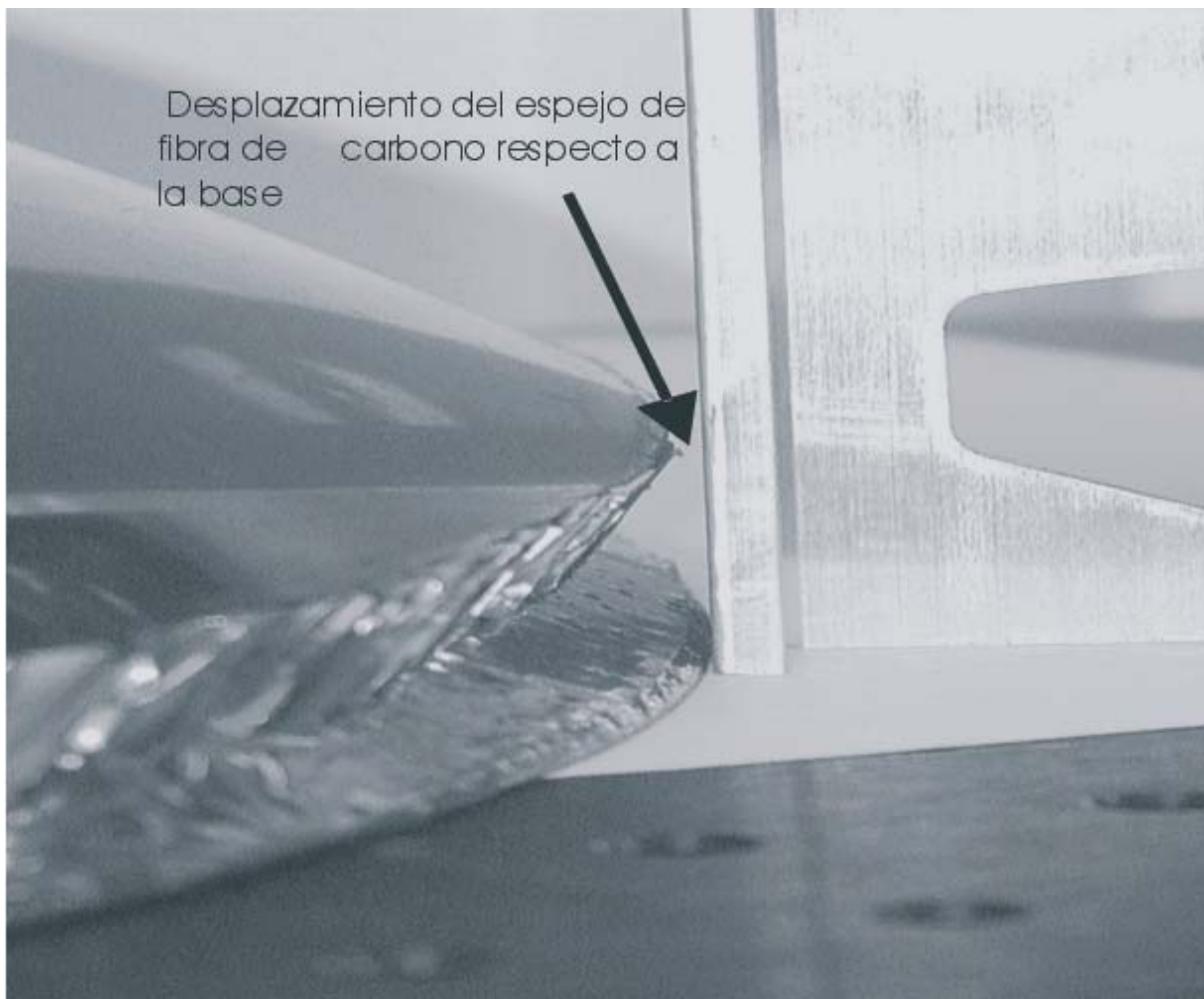
Fig.4.15 Desplazamiento del espejo de fibra de carbono respecto a la base.
