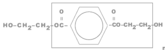
Figura A5.7: Estructura del PET
