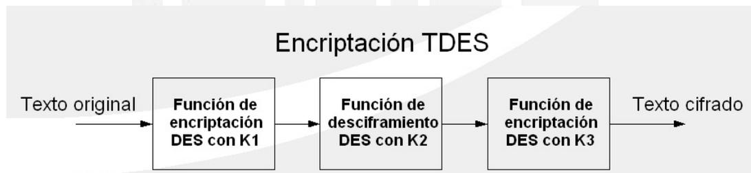
Fig. 4.2 Diagrama funcional de DES Triple
