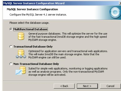
**Figura A-MT-1.4-6 Soporte a distintos tipos de base de datos**
