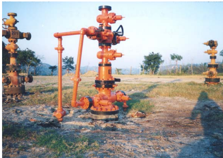
Fig. 3.16 Árbol de Válvulas Mixto
