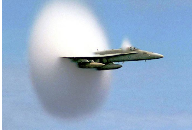
Figura 1.1: Condensación en un avión supersónico
