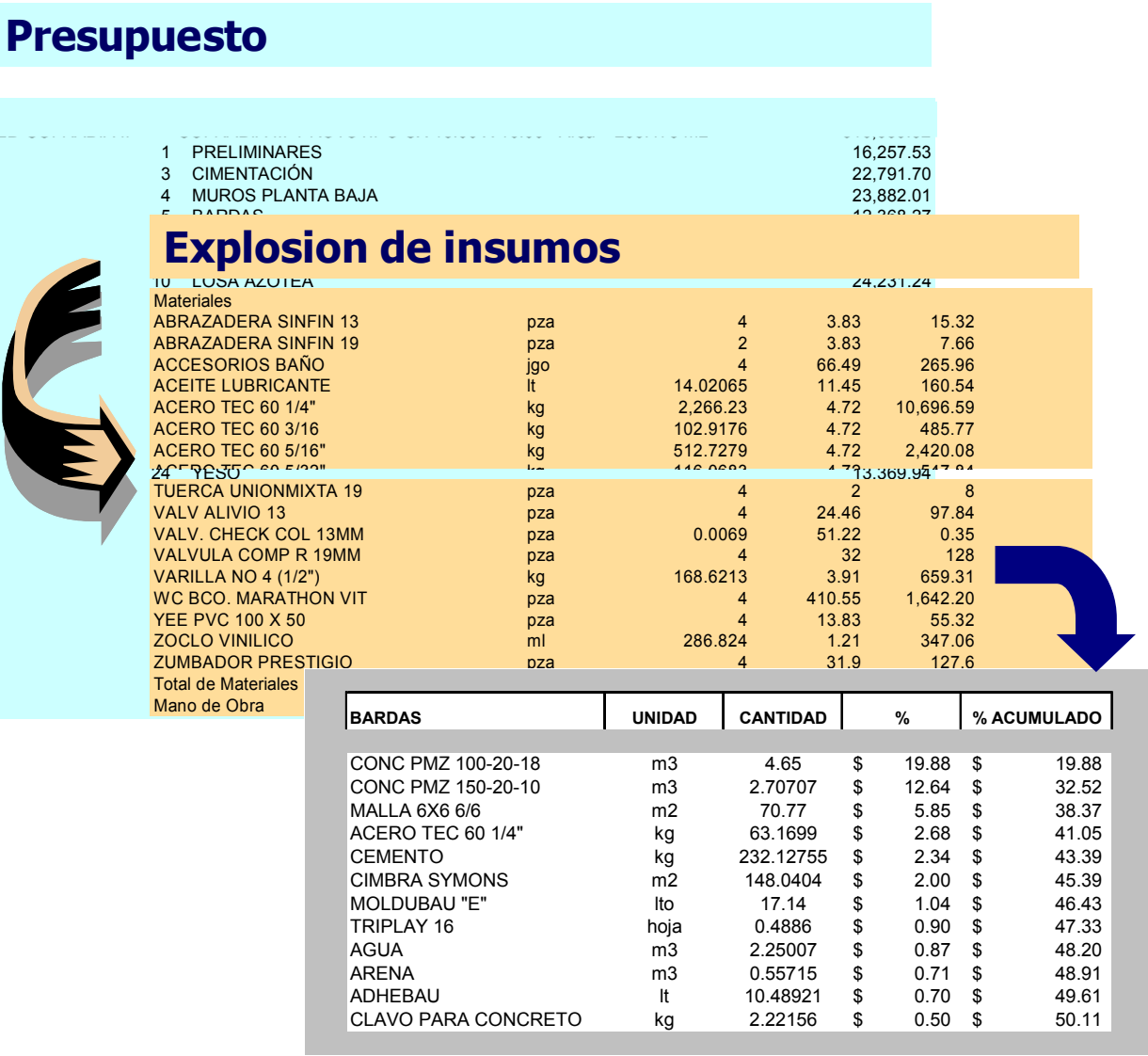
Figura 30. A partir del presupuesto, es posible realizar la explosión de insumos y clasificar de estos, aquellos que tienen mayor importancia. (Elaboración propia)
