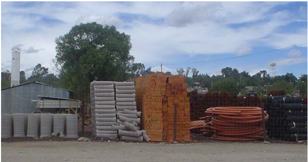
Figura 41. Estibado de mampostería, tubería de concreto simple y tubería de pvc. No se observan unidades o paletizaciones.(Fuente:propia)
