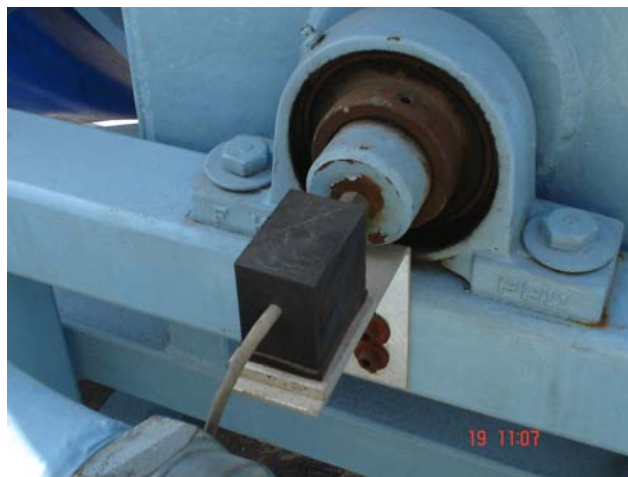
Fig. 2.41. Colocación del sensor de posición.
