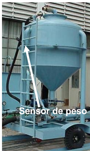
Fig. 2.39. Colocación del sensor de peso.
