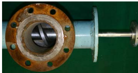
Fig. 2.36. Colocación del tornillo sin fin dentro de la carcasa.
