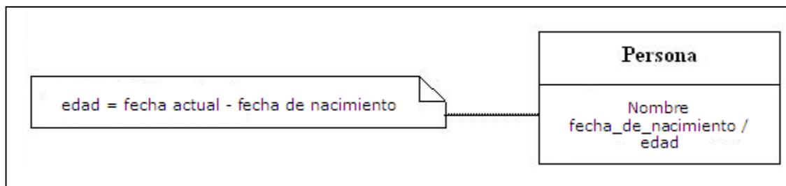
Figura 2.4.12.1 Notación gráfica de UML para los elementos derivados
