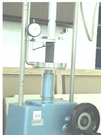
1. Se dan incrementos de cierto número de unidades. Y se hace que permanezca el valor a lo largo de un minuto antes de tomar la lectura del extensómetro (tomando el primer valor como un pivote) que actúa como el cero de las deformaciones de la probeta. Los incrementos de carga se aplican en periodos de 1 minuto hasta que falle la probeta o se detiene la prueba cuando se alcanza el 20 % de la deformación de la misma.
