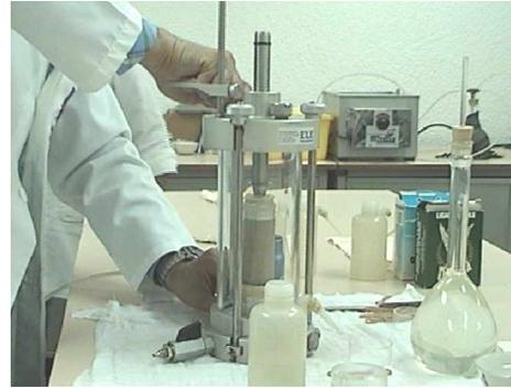
11. Se sube el agua para aplicar finalmente presión con un valor aproximado de 50 kPa.
