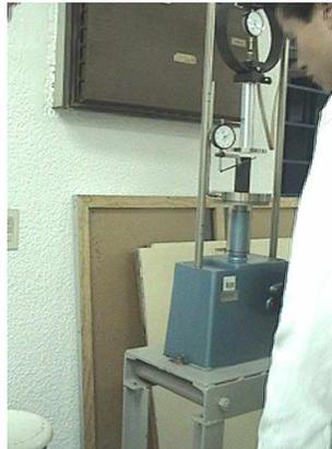
El instructor proporciona la constante del anillo de carga para que el alumno estime la carga en función del número de unidades (rayitas) que se programen para cada incremento de carga. Se programan incrementos para llegar a la falla con por lo menos diez incrementos.
