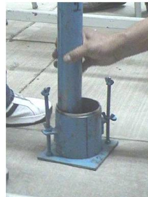
5. Después se lleva el molde a la báscula otra vez, para igualar la masa al valor de la masa del molde y dos capas, y se aplican otros 25 golpes.
