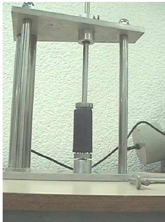
1. Para obtener el volumen de la probeta se miden los diámetros con el vernier; uno al centro otro en la parte superior y otro en la inferior de la misma. Apenas al toque y sin lastimar la probeta. Para obtener el diámetro medio o promedio el cual se obtendrá en los cálculos más adelante.
