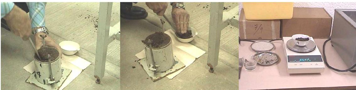
11. Ya medida la masa de la muestra se lleva al horno durante 24 horas o más . Si es posible se enfría en un desecador y se vuelve a medir la masa del recipiente más la masa del suelo seco.
