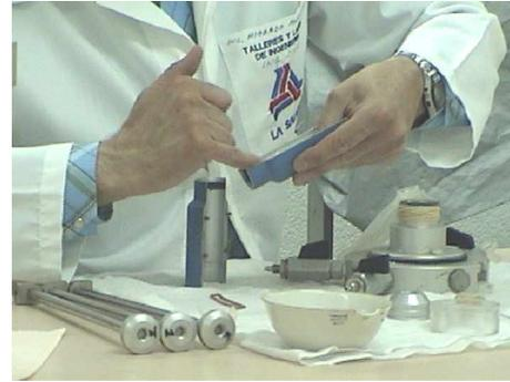
4. Se fija con una liga briada a la base de la cámara, utilizando un expansor de lucita. Se le hacen cuatro dobleces, y se coloca en la base de la cámara. Por último se pone otra liga casi a la altura de la piedra porosa para asegurar que la arena no baje más allá de esta.
