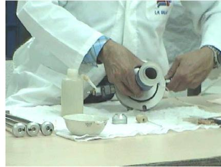
6. El molde se llena con agua para que no quede atrapado aire en la estructura sólida del suelo (arena) Se le coloca una extensión al molde.
