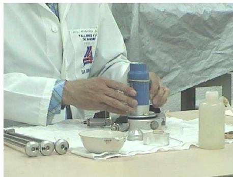
5. Se coloca el molde metálico con una liga doble y un forro de papel en la pared interna, se coloca sobre la base y se pasa la membrana a través del molde, se conecta el vacío al molde para que la membrana se pegue a las paredes de éste.
