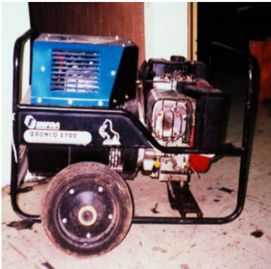
FIGURAS 5.8 A Y B MUESTRAN UN GENERADOR DE CORRIENTE PARA SOLDADURA ELECTRICA NUEVO Y UN KOLLMAN 1500 CON UNA CANASTILLA DE CHICOTE CON UNA PUNTA IMPROVISADA.
