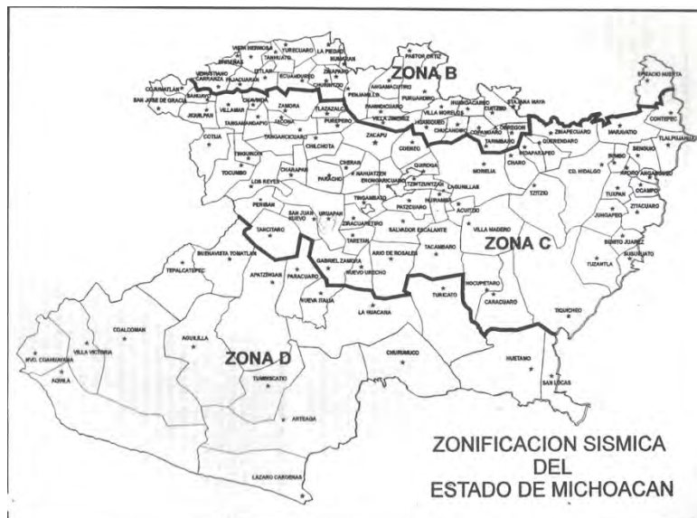
Imagen 3.3 Zonificación sísmica en el estado de Michoacán
