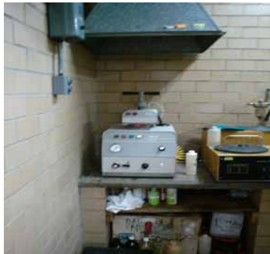
fig. 5.6 Montadora de probetas
