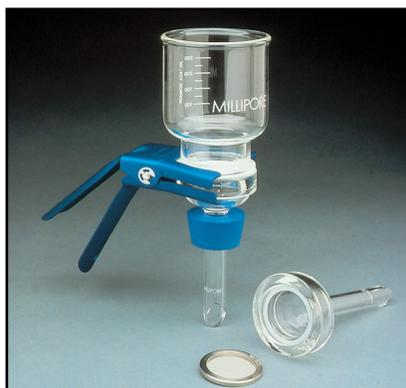
**Fig. 12** Equipo completo Filtro de Membrana Millipore.
