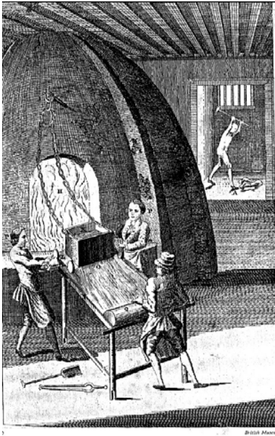
Fig. 1.32 El primer método de fabricación de vidrio plano como fluido en movimiento 1688-1702 McGrath .
