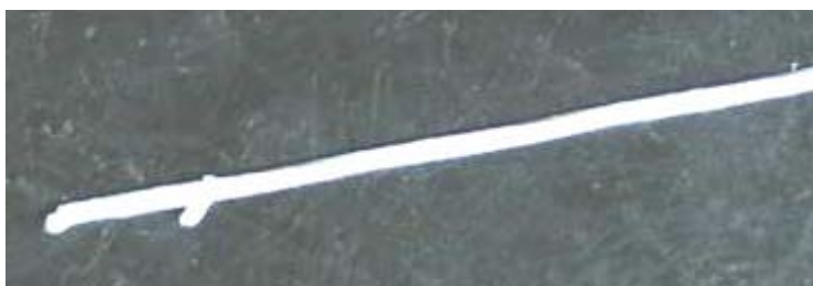
Figura 4.5. Imagen real mostrando el maso de tres fibras centelladoras.
