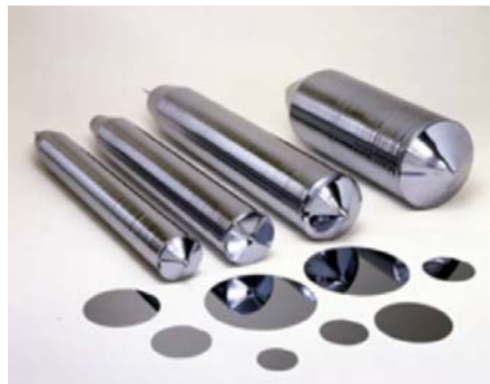
Figura 1.5 Barra de Polisilicio.
