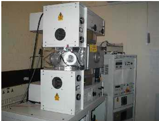
Figura 1.13 Equipo para sputtering mediante radiofrecuencias y magnetrón. NORDIKO NM2000 RF.
