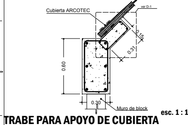
TRABE PARA APOYO DE CUBIERTA esc. 1 : 10
