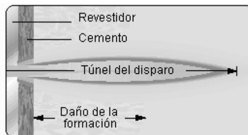
Figura V.4. Daño provocado por los disparos.
