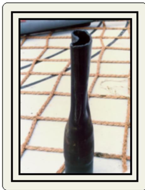
Figura II.6. Colapso de una tubería
