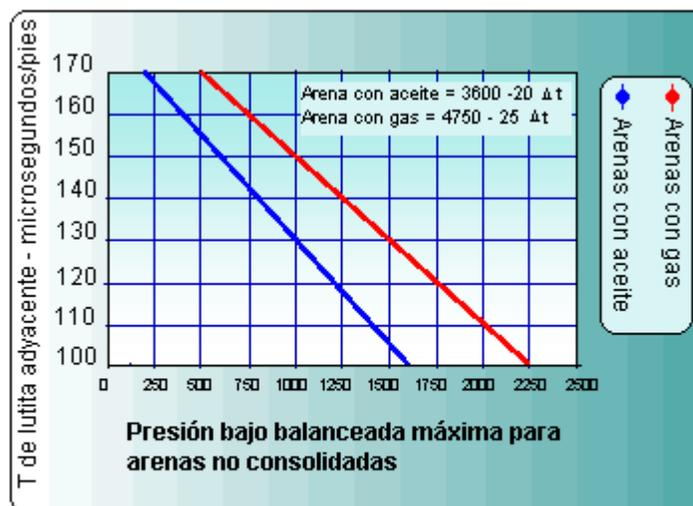
Figura III.67. Gráfico para determinar la presión diferencial máxima en arenas no-consolidadas con el registro sónico.
