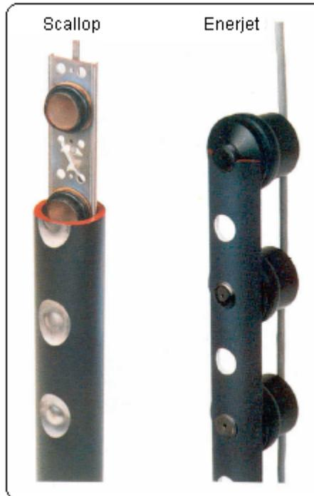
Figura III.54. Pistolas usadas a través de tubería.
