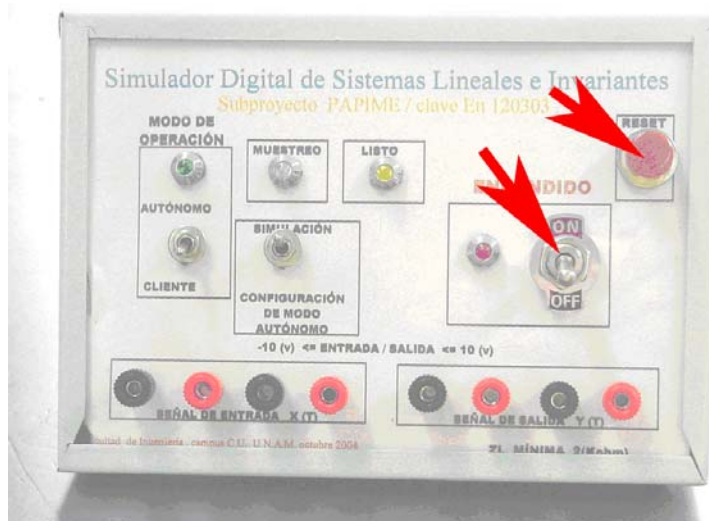
Figura 89.- Switch “ENCENDIDO” que se debe mover a la posición “ON” y presionar “RESET”
