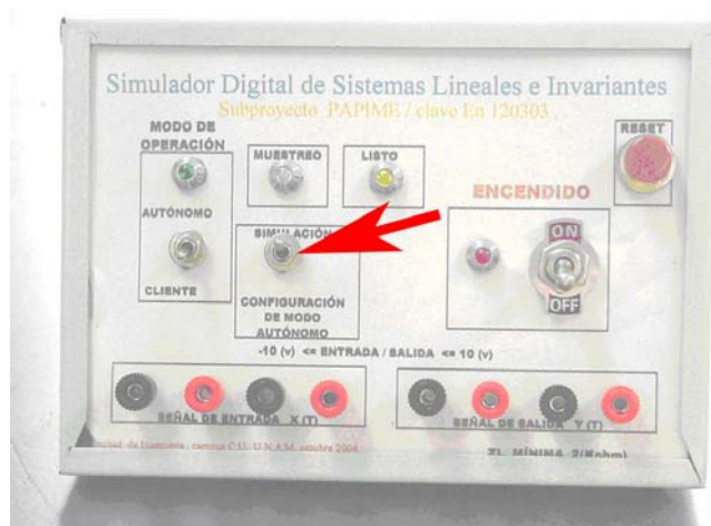
Figura 83.-Switch que se debe mover a la posición “SIMULACIÓN”
