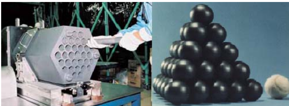
Figura 9. Comparación de los tipos de combustible utilizados por el HTTR (izquierda) y por el reactor Pebble-Bed (derecha)
