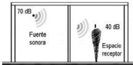
Figura 38. Ilustración esquemática de la atenuación de ruido aéreo.
