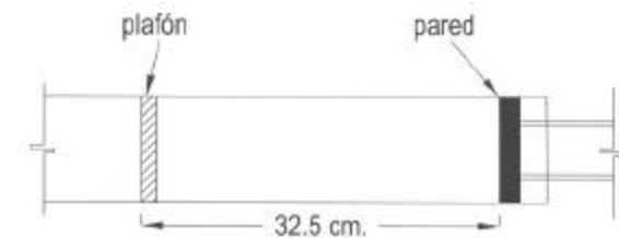
Figura 33. Montaje de la muestra. Entre la muestra de plafón y la pared hay una cámara de aire de aproximadamente 30 cm.
