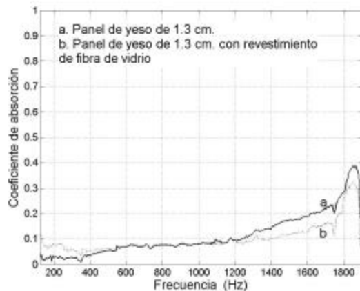
Figura 30. Coeficientes de absorción de panel de yeso con y sin revestimiento de fibra de vidrio.
