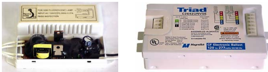
A B Figura 2.32 Balastos electrónicos para sistemas dedicados Fuente: Fotografías de diversas marcas
