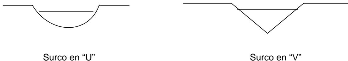
Figura 2.1 Secciones de los surcos de riego
