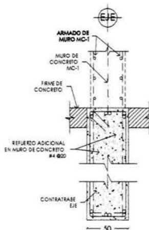
ANCLAJE DE MURO MC-1 EN CIMENTACION D-04
