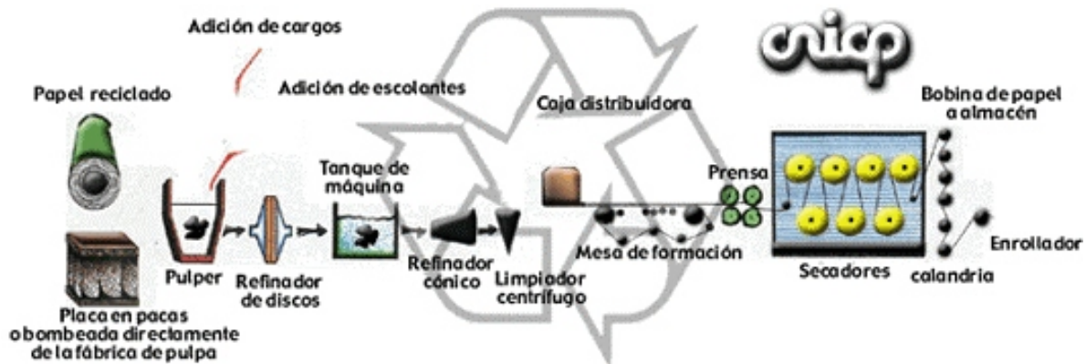
Fig. 1 Secuencia de fabricación del papel
