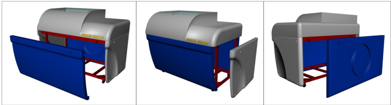
Fig. 32 Montaje de las cubiertas
