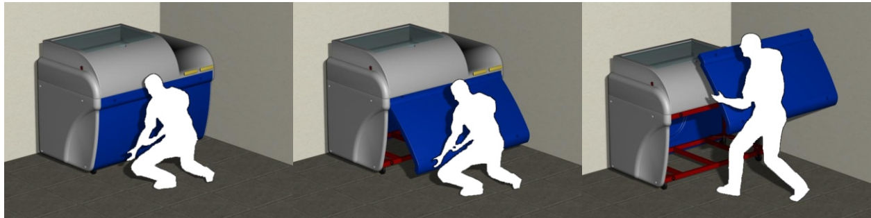
Fig. 40 Desmontaje de la cubierta frontal
