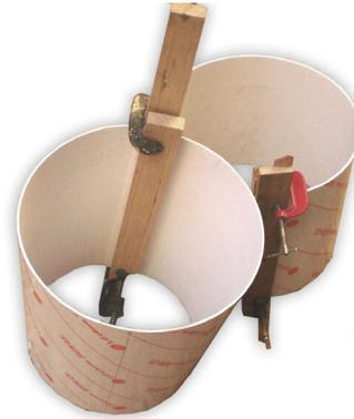
2.- parte externa del depósito. Se utilizaron anillos de MDF y se formaron los cilindros para la parte externa de l depósito con el PVC laminado y se fijó con grapas a todo lo largo.
