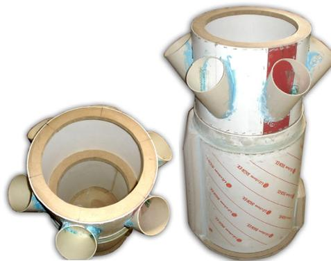
4.- para los alojamientos donde se va a sembrar, se utilizó el tubo de PVC y se corto a la medida y con los grados de incitación necesarios, igualmente las tapaderas se cortaron los círculos de PVC laminado. Posteriormente se unieron con pegamento para PVC y se dieron los radios con relleno plástico,
