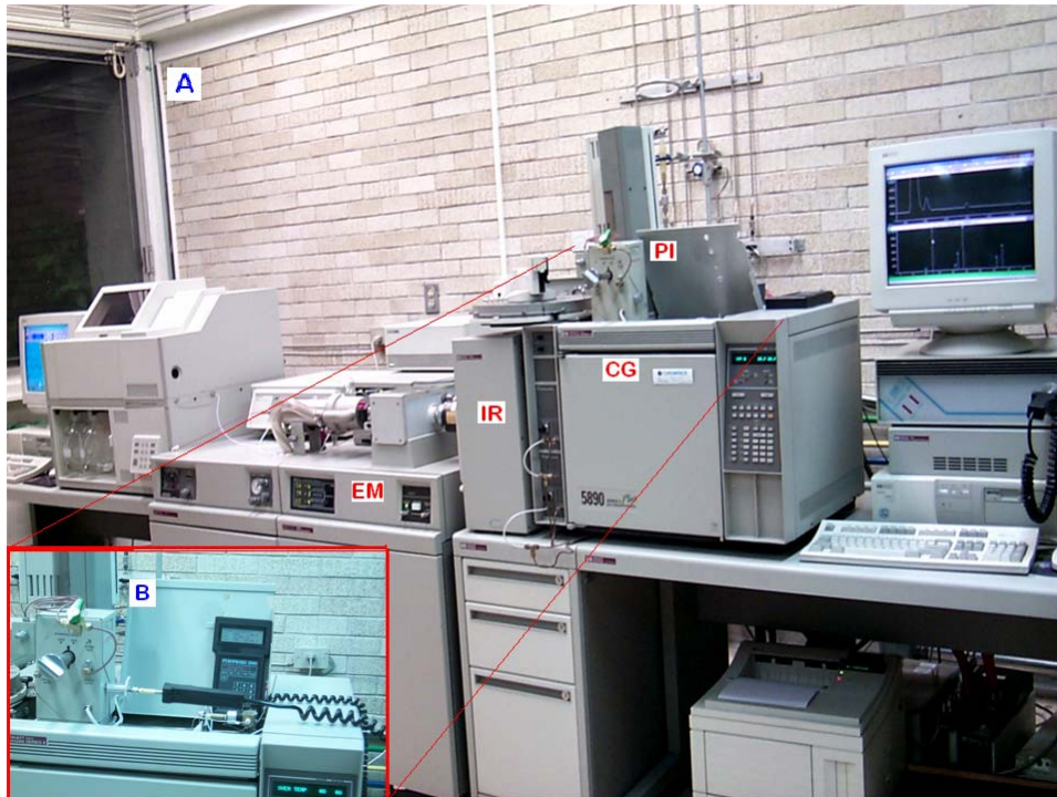
Figura 4.2 A) muestra el sistema de acoplado de análisis donde: PI= pirolizador CG =Cromatógrafo de Gases, IR= espectrofotómetro de infrarrojo; EM=espectrómetro de masas, B) Es una fotografía ampliada del sistema de pirólisis, el controlador, cámara y sistema de inyección. La figura B muestra un acercamiento de la probeta de pirólisis.
