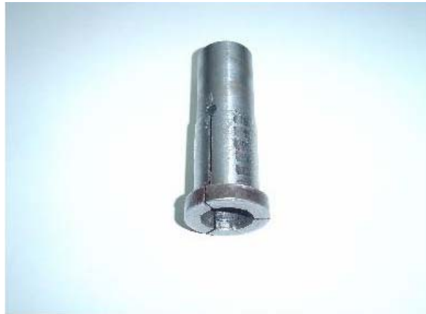
FIGURA 4.7 .- BOQUILLA PARA LA PIEZA QUE ES COLOCADA EN EL CHUCK DEL TORNO.
