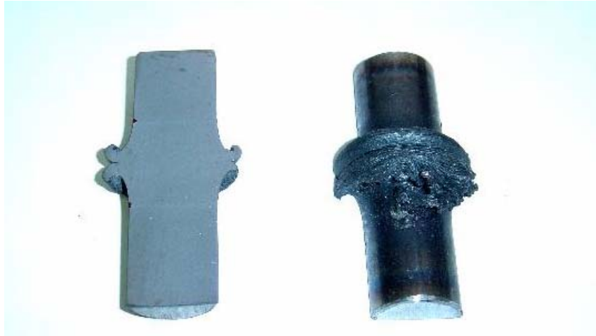
FIGURA 4.11 .- CORTE DE LAS PROBETAS PARA METALOGRAFIA.
