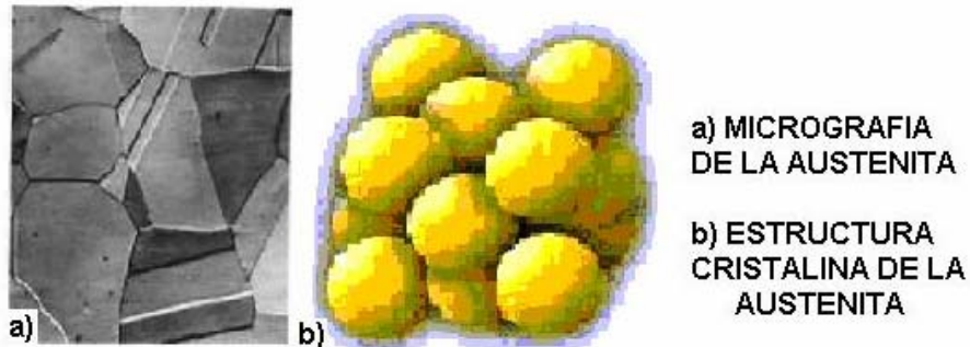
FIGURA 3.6 .- ESTRUCTURA DEL HIERRO ENTRE LOS 900 Y 1400 °C.
