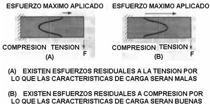
FIGURA 3.20 .- EFECTO DE LOS ESFUERZOS RESIDUALES.
