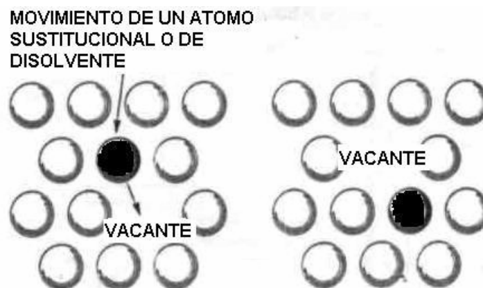
FIGURA 3.16 A .- REPRESENTACION ESQUEMATICA DE UNA DIFUSION.
