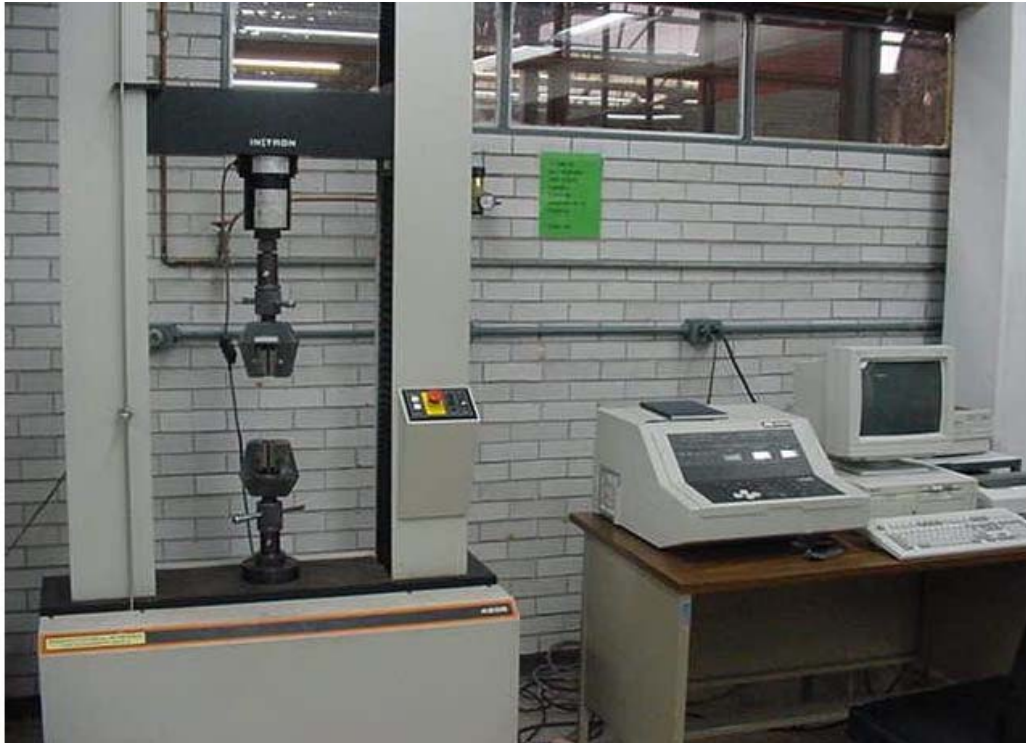
FIGURA 4.16 .- MAQUINA PARA EL ENSAYO DE TRACCION.
