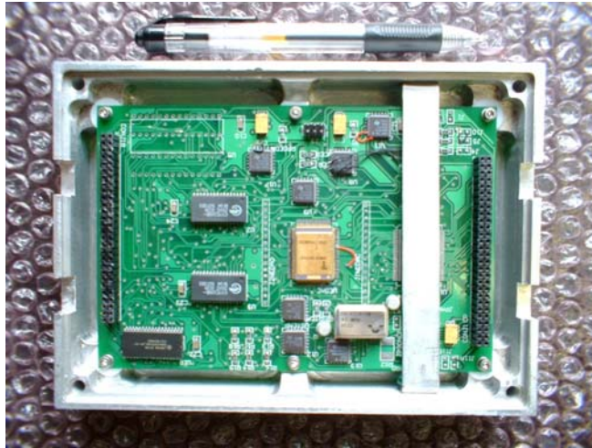
Figura 5-9 Computadora de vuelo del NS en una moldura de aluminio.
