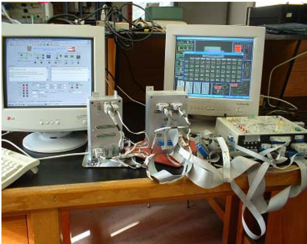
Figura 4-1 Interconexión de los equipos del satélite para realizar las pruebas entre SET y satélite.
