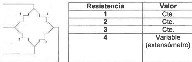
Figura 3.4 Arreglo en cuarto de puente
