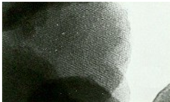
Fig. 3.15: Micrografía de MCM-41 en la que se aprecian los mesoporos en la matriz de silicio y el arreglo tipo panal. Esta Micrografía corresponde al material sintetizado experimentalmente.
