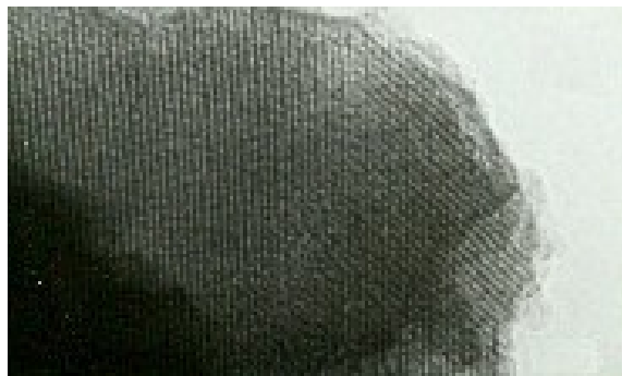
Fig. 3.16: Micrografía TEM de una muestra de Ti-MCM-41 en la que se aprecia la alta densidad de las paredes que le confiere el Ti, pero sin afectar la morfología hexagonal del material.
