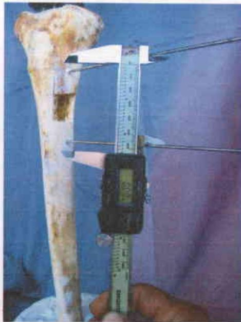
*Fig. 8. Inserción de Clavos y colocación de pie de rey.*
