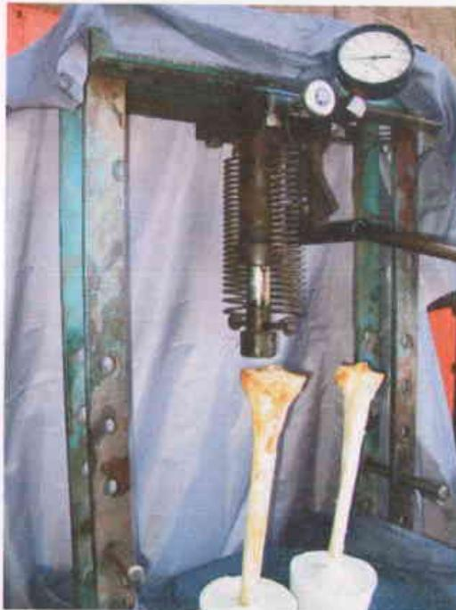
*Fig. 10. Medición del Pandeo y fractura total por ciclos de fuerza.*
