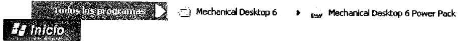
Figura 1.1 Trayectoria a seguir para iniciar el programa MD desde el botón de inicio
