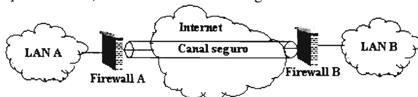
Fig. 3.4.5.8.3.1. Túnel (VPN) entre dos firewalls.
