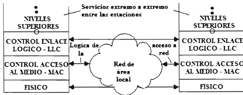
Fig. 2.5.5.3 Arquitectura de comunicación en una red LAN
