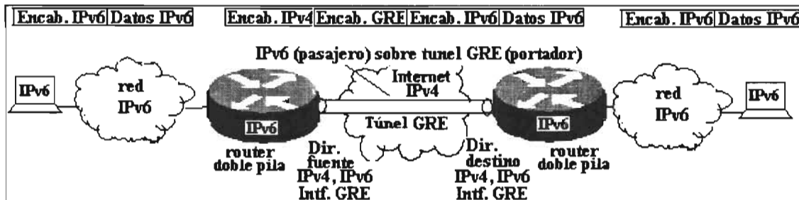
Fig. 3.4.8.2.2 IPv6 sobre túnel GRE.
