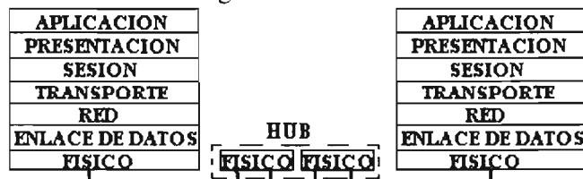
Fig. 2.5.6.1.5.1.1 Nivel de funcionamiento de un HUB
