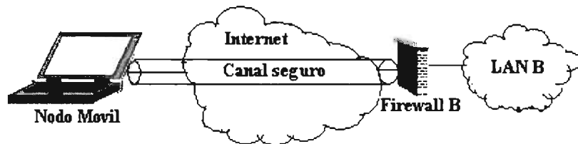
Fig. 3.4.5.8.3.3 Túnel (VPN) entre un firewall y un host.
