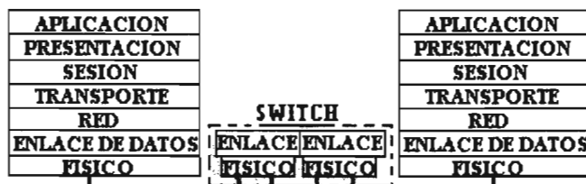
Fig. 2.5.6.1.5.4.1 Nivel de funcionamiento de un switch
