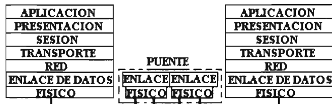
Fig. 2.5.6.1.5.3.1 Nivel de operación de los puentes
